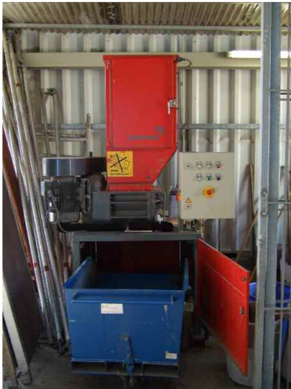
Abbildung 5-1 Rotorschern mit 16 und 8 mm Messerbreite
