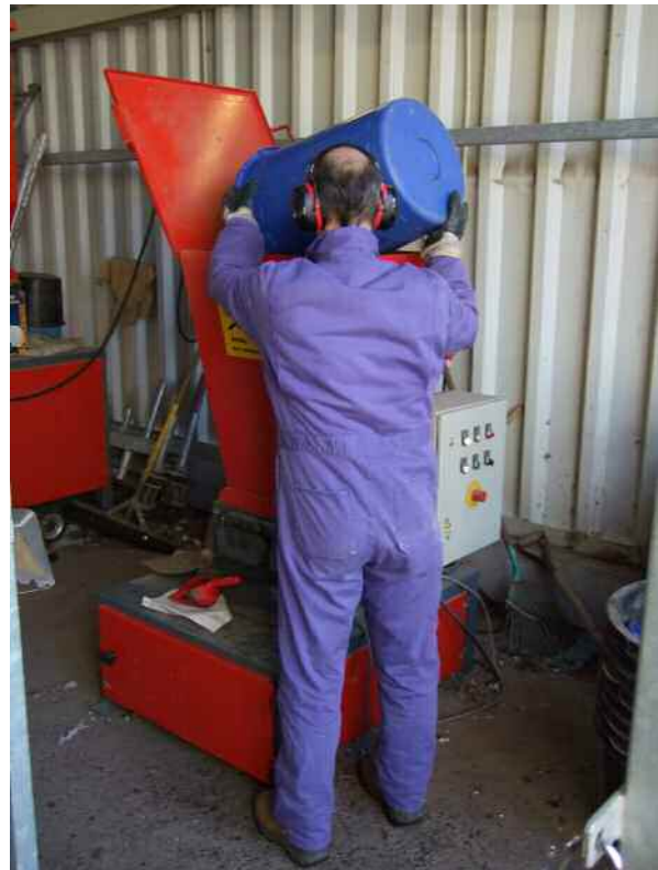
Abbildung 5-1 Rotorschern mit 16 und 8 mm Messerbreite
