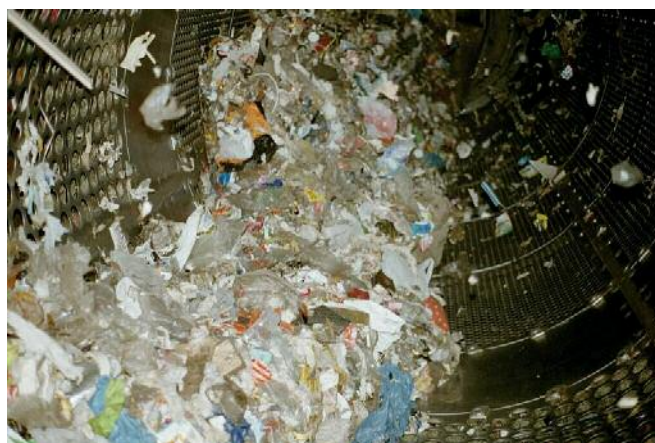
分层过滤, 滚筒式分离粗糙(轻)和精细(重)物质。
